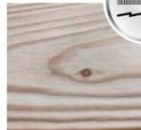
**Strukturierte Oberfläche:** Als Grundlage dient eine gehobelte Oberfläche. Diese wird intensiv mit mehreren Bürsten bearbeitet. Da Weichhölzer wie Fichte weiche und harte Jahresringe besitzen, bürsten sich diese unterschiedlich stark aus. Es entsteht eine „wellige“ Oberfläche mit sehr deutlicher, plastischer Holzstruktur.
