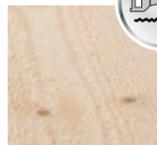
**Feingesägt und gebürstet:** Mit einem präzisen Bandsägeschnitt werden die zu verarbeitenden Holzbalken aufgetrennt, wodurch eine sägeraue Oberfläche entsteht. Durch mehrmaliges aufwändiges Bürsten werden lose Holzfasern entfernt, um höchste Qualität zu gewährleisten. Eine feingesägte und gebürstete Oberfläche bietet den besten Untergrund für jede Farbbeschichtung.
