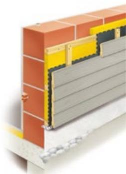
Wandaufbau der Massivbauweise.
